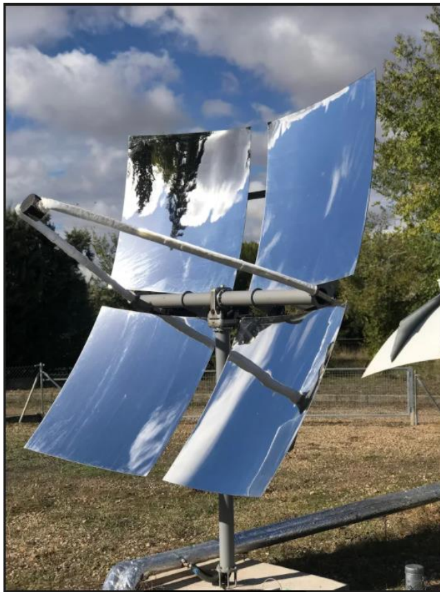
Figuur a: Afbeelding van een TCT spiegel, waarbij met geconcentreerd zonlicht warmte geproduceerd wordt.
